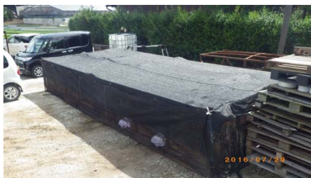
試験木を鉄枠に入れ、寒冷紗をかけて鳥から守った状態
